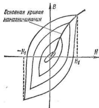
Рис. 7.7. Основная кривая намагничивания и семейство петель гистерезиса
