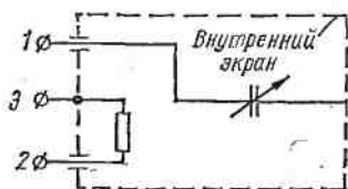
Рис. 3.27. Схема электростатического вольтметра на низкие напряжения
