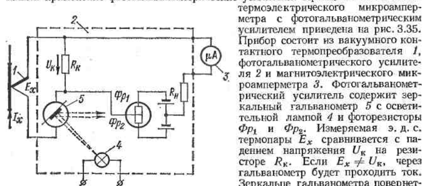
Рис. 3.35. Схема термоэлектрического микроамперметра с фотогальванометрическим усилителем
